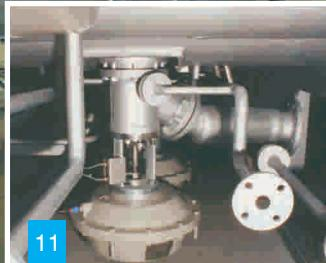
Das AMK-Programm enthält neben Auspress-Kneter auch Kneter mit feststehend angeordnetem Bottich und Bodenentleerung mittels Ventil, Klappe oder Schieber.
